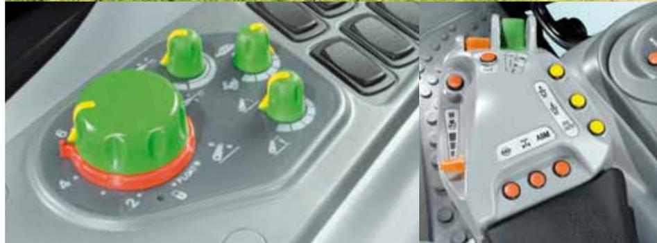
acoplamientos de la tracción integral y del bloqueo de los diferenciales. Al no tener que hacer estas operaciones manualmente, el conductor puede dedicar toda su atención a la labor en curso.
